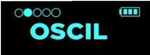
Con este modo se leen las formas de onda de los circuitos eléctricos del vehículo. Cuando se activa este modo, se leen las formas de onda en tiempo real.
