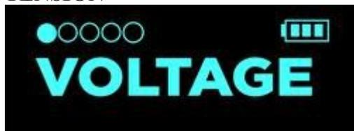
Utilizando este modo, podemos medir la tensión en el cable y comprobar qué cable es el de alimentación o el de tierra.
