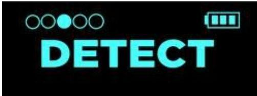
Con este modo puede identificar el tipo de bus digital. Al entrar en este modo, la pantalla mostrará "read" después de tocar un cable del mazo eléctrico del vehículo, el control comenzará automáticamente a identificar el tipo de bus digital. Si la señal digital se identifica positivamente, aparecerá un mensaje en la pantalla (CAN lo, CAN hi, etc)
